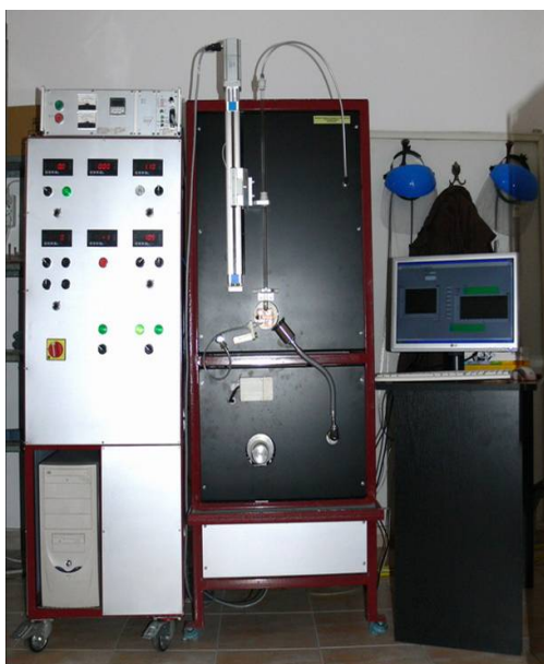
Fig. 3. Instalația de preparare a firelor submicronice și nanofirelor amorse cilindrice acoperite cu sticlă de la INCDFT-IFT Iași.
