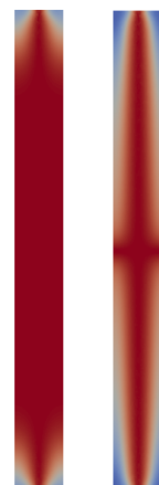
Fig. 19. Secțiuni longitudinale prin două nanofire cilindrice amorse: unul cu \lambda \approx 0 (stânga) și celălalt cu \lambda \gg 0 (dreapta).
