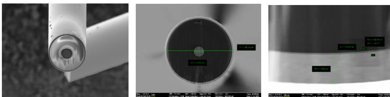
Fig. 1. Imagini SEM a unui fir magnetic compozit multistrat și detalii privind geometria acestuia.
