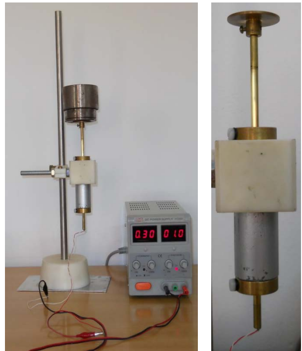
Fig. 1. Schema constructivă a amortizorului cu fluid magnetoreologic, proiectat și executat în laborator
