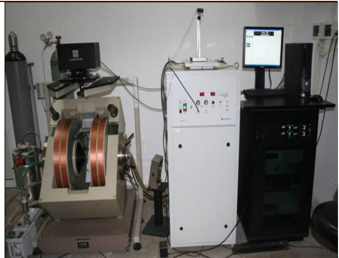
Magnetometru cu probă vibrantă (model LakeShore VSM 7410): H = 0 \div 3,2 \text{ T} ; T = 4 \div 1300 \text{ K} , echipat cu modul pentru determinarea magnetorezistenței MR ( T = 4,2 \div 450 \text{ K} )
