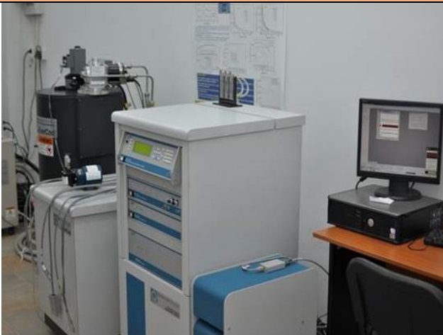
Sistem de măsurare a proprietăților fizice (model QD PPMS-9), cu module VSM, susceptibilitate c.a., capacitate calorică, rezistivitate, efect Hall și Seebeck, echipat cu celulă de presiune hidrostatică ( 15 \div 30 \text{ kbar} )
