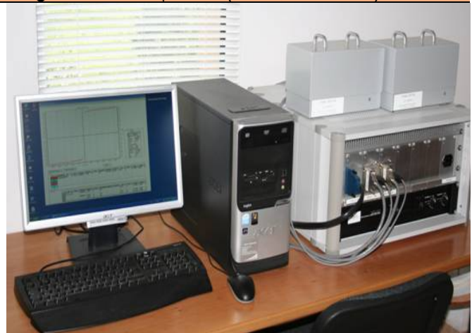
Hysterezisgraf HyMac cu accesorii, pentru domeniul de frecvențe 30 \text{ Hz} \div 3 \text{ kHz}
