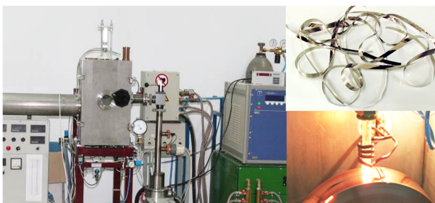
Instalație de preparare a benzilor magnetice amorse la INCDFIT-IFT Iași.
