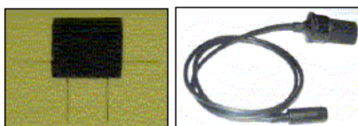
Senzor magnetorezistiv pe bază de manganiti \text{La}_{0.54}\text{Ho}_{0.11}\text{Sr}_{0.35}\text{Mn}_{1-x}\text{Cu}_x\text{O}_3 și montură
