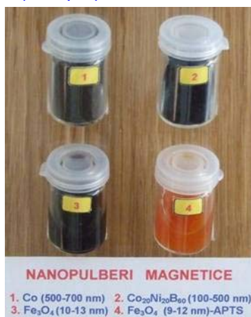
Nanopulberi magnetice. Utilizare: realizarea de micro- și nanodispozitive cu aplicații în biologie, medicină și microelectronică; aplicații catalitice.
