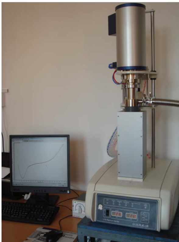
Dilatometru LINSEIS L75 VS 1000 (pe display este prezentată variația lungimii probei în funcție de temperatură, pentru un eșantion sub formă de bară dintr-un aliaj cu memoria formei).
