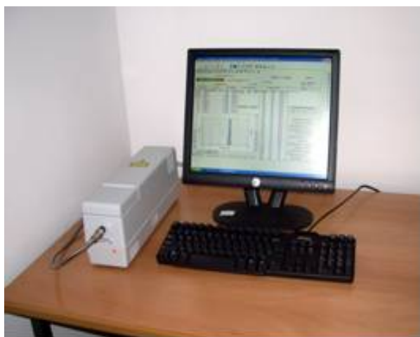
Model MICROTRAC/ NANOTRAC 252 pentru domeniul 0,8 \text{ nm} \div 6,54 \text{ }\mu\text{m} , cu mod de lucru wet/dry
