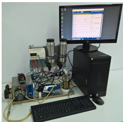
Fig. 1(a). Vedere de ansamblu a instalației de obținere CDs imidici.
