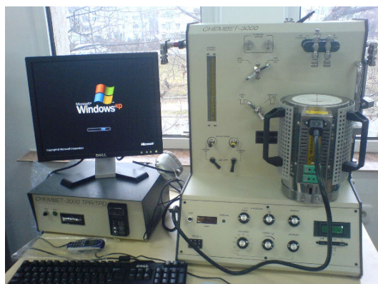
Aparat CHEMBET 3000 TPR/TPD pentru măsurarea cineticii de absorbție/desorbtie a gazelor în/din materiale poroase, la temperatura camerei și temperaturi înalte
