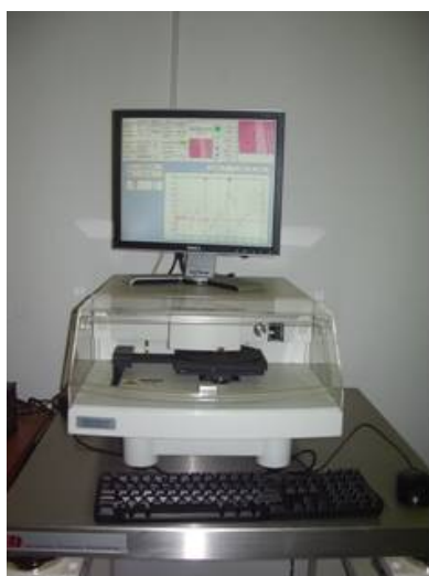
Model MICROTRAC/ NANOTRAC 252 pentru domeniul 0,8 \text{ nm} \div 6,54 \text{ }\mu\text{m} , cu mod de lucru wet/dry
