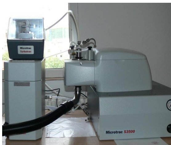
Model MICROTRAC S3 500 pentru domeniul 0,243 \div 2816 \text{ }\mu\text{m} , cu mod de lucru wet/dry
