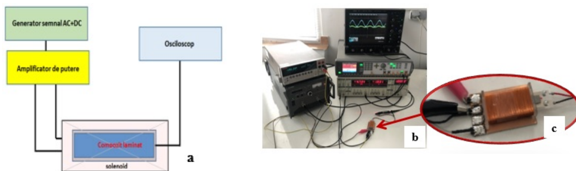
Fig. 7. (a) Schema de principiu a montajului experimental; (b) montajul experimental utilizat pentru testarea eficacității noilor structuri magnetoelectrice compozite laminate și (c) sistemul de bobine în care se introduce compozitul laminat supus testării.
