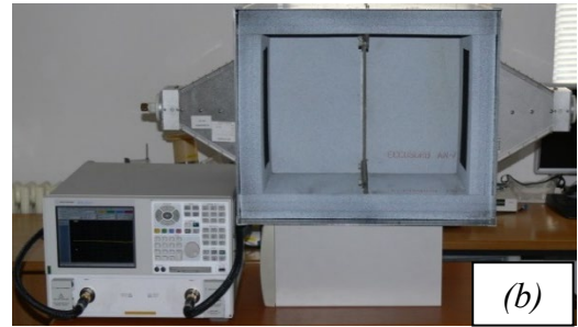
Fig. 7. (a) Reprezentarea schematică a montajului experimental cu antene de microunde; (b) Sistemul de măsură utilizat pentru determinarea proprietăților de absorbție ale metastructurilor plan rigide în intervalul 1 \div 18 GHz.
