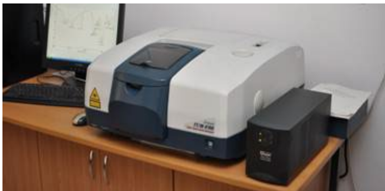
Spectrometru în IR cu transformată Fourier FT-IR (model JASCO 6100), cu o precizie \leq 0,5 \text{ cm}^{-1}
