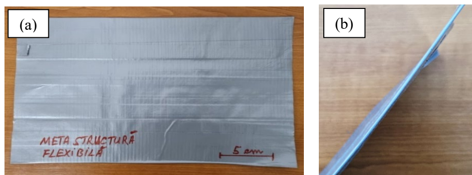
Fig. 8. Metastructuri flexibile pe bază de microfire FINEMET: (a) imagine de pe suprafața metastructurii; (b) imagine în secțiune transversală.
