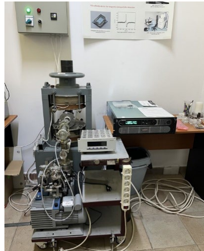
Fig. 6. Instalație pentru tratamentul termic al torurilor magnetice în câmp magnetic (Instalația poate fi utilizată și pentru alte tipuri de materiale cu alte geometrii).
