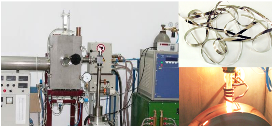
Instalație de preparare a benzilor magnetice amorfe la INCDFD-IFT Iași.
