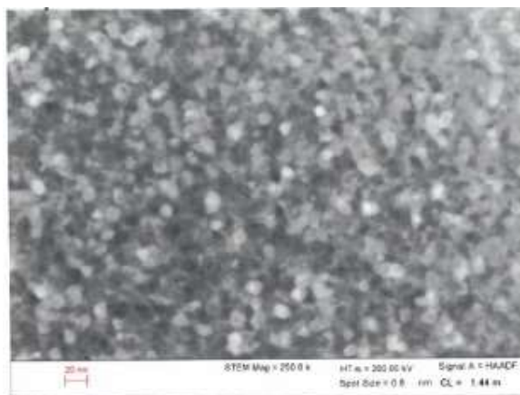
Fig. 11. Imaginea TEM pentru un microfir Fe-Si-B-Cu-Nb (FINEMET), trefilat și tratat termic la 500 °C, evidențiază prezența grăunților nanocristalini în matricea amorfă reziduală.
