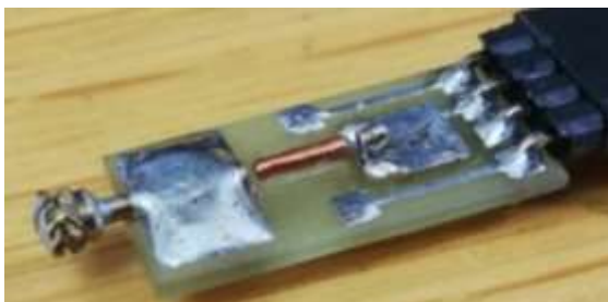
Fig. 13. Fotografia părții sensibile a senzorului utilizat în experimente de modificare a unghiului de torsiune.
