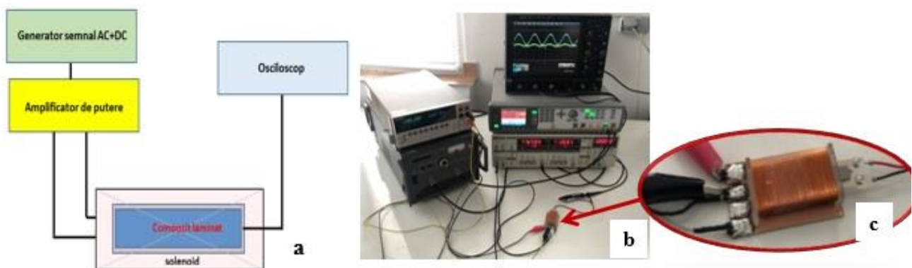
Fig.7. (a) Schema de principiu a montajului experimental; (b) montajul experimental utilizat pentru testarea eficacității noilor structuri magnetoelectrice compozite laminate și (c) sistemul de bobine în care se introduce compozitul laminat.
